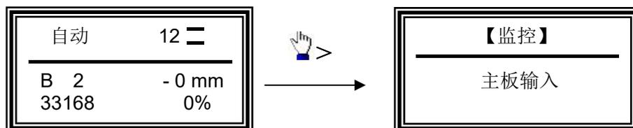
【状态监控】菜单有 9 个子菜单，分别为【主板输入】、【外呼通信】、【内呼登记】、【上呼登记】、【下呼登记】、【轿厢输入】、【轿厢输出】、【电流电压】、【数据监控】各子菜单之间的切换及监控翻页按“^”“v”键，进入子菜单按“ENTER”键，进入子菜单后按“MENU”键返回，再按“MENU”键回初始化界面。
