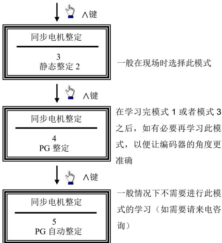
8、如能脱开负载（在工厂中或者现场没有悬挂钢丝绳时），则整定模式设为 1，进行旋转型同步电机自学习。
