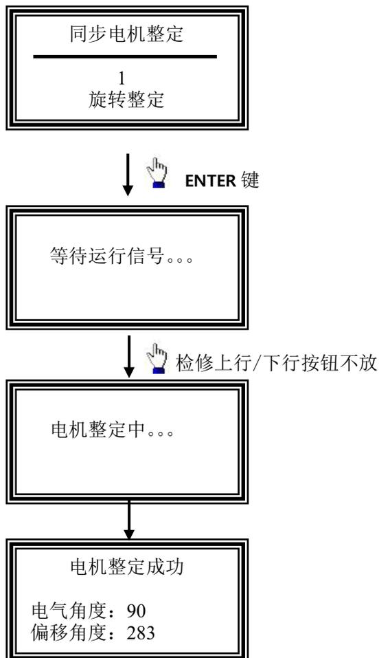
9、如不能脱开负载（现场已经悬挂钢丝绳时），则整定模式设为 3，进行静止型同步电机自学习。
