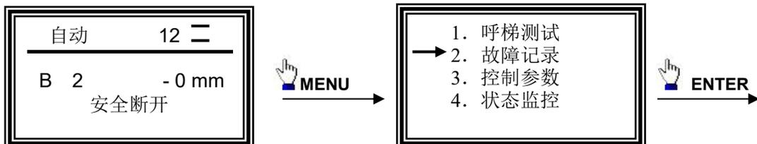
注：电梯在运行中发生故障，在液晶操作器最下一行位置显示当前故障名称，故障排除后，按“ENTER”键消除故障显示，如不能消除，则表示该故障一直存在。
