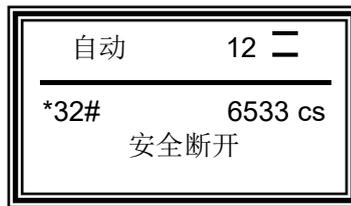
电梯在运行中发生故障后，在液晶屏最下面一行显示当前故障名称，按“ENTER”键消除；如不能消除，则表示该故障一直存在，请排除故障。
