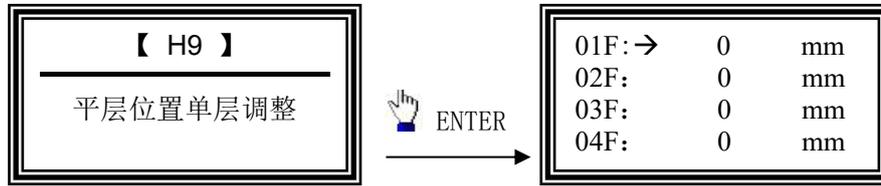
保持在此界面不动，调试人员进入到轿厢中；使用呼梯按钮运行至需修改的楼层，电梯到达目标楼层开门后，**按住开门按钮不放**。点击（不能按住不放）最高层的呼梯按钮，为提高平层位置；点击最底层呼梯按钮，为降低平层位置。此时，轿厢显示板会显示您所设置的数据，上箭头为 $\geq 0$ ，下箭头为 $\leq 0$ 。设置完成后，松开开门按钮，轿厢显示板恢复正常显示，继续运行至其他楼层进行设置。
