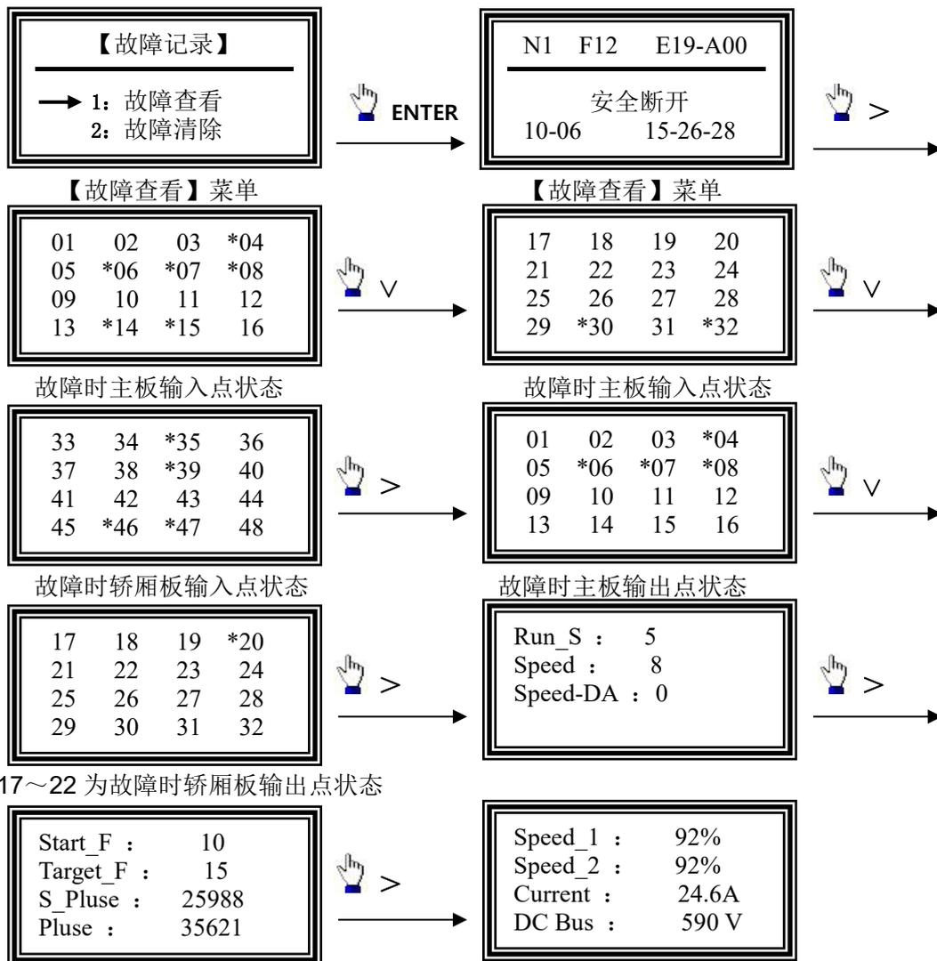
Run\_S: (故障时的内部状态) 0: 待机; 1: 开门; 2 等待关门; 3: 启动计算; 4: 预启动; 5: 快速运行中; 6: 减速中 (未到达目标层, 未收到平层信号); 7: 减速中 (已到达目标层, 未收到平层信号); 8: 减速中 (收到 1 个平层信号); 9: 减速中 (收到 2 个平层信号); 11-13: 返平层中; 15: 停车中。
