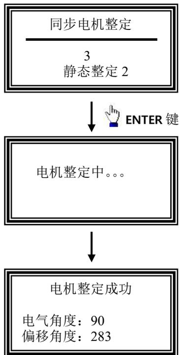
10、在进行完整定模式 1（旋转）或者整定模式 3（静止）成功之后，电梯就能够正常运行检修了。如现场调试人员认为编码器信号不准确，可以再进行一次整定模式 4 的学习，以便让编码器的角度学习得更准确，整定模式 4 的学习学习完成后要再进行一次整定模式 1 或者整定模式 3 的学习。
